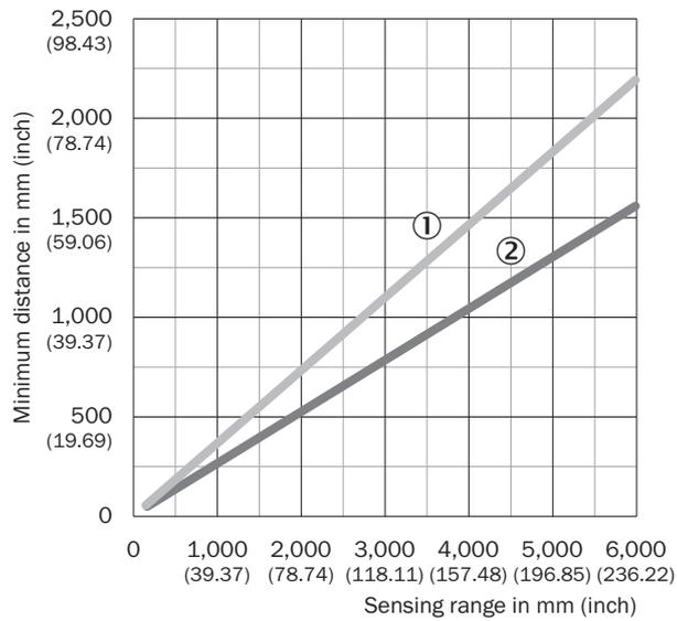
Lors d'une installation qui n'est pas réalisée en sens opposé il faut respecter une distance minimale entre les deux paires de rideaux de détection
