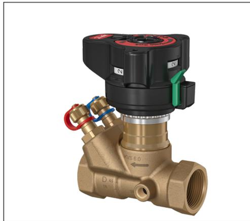
L'ASV-D est une vanne associée à utiliser avec les vannes d'équilibrage dynamiques ASV-PV/P ou AB-PM pour régler la pression différentielle dans les boucles. L'ASV-D est une vanne de pré réglage et d'arrêt combinée, offrant un ensemble de fonctions uniques :
