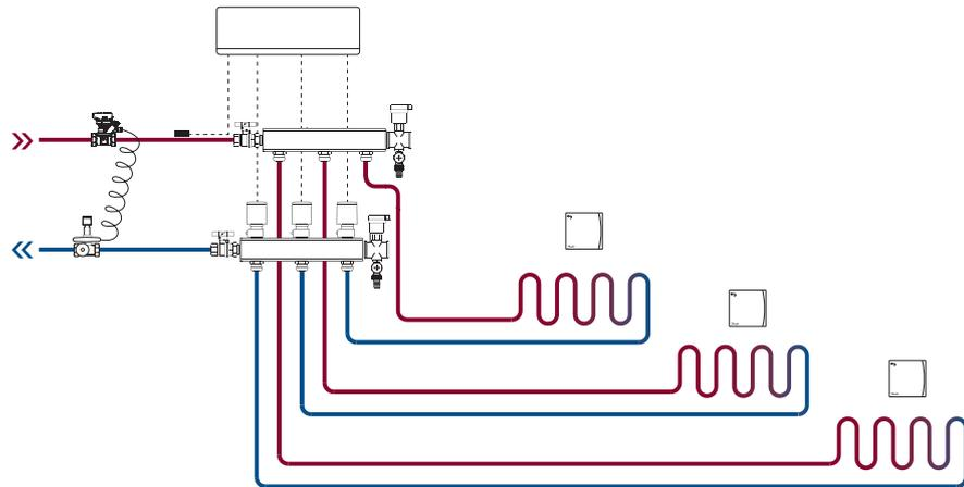
Exemple 2 : système à 2 tubes avec kit de mélange (contrôle de la température d'alimentation optionnel)
