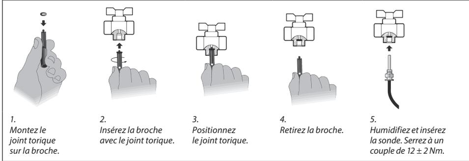
Pour garantir la précision et l'étanchéité, l'installation de la sonde doit être conforme à la norme EN1434-2 annexe A :
