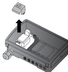
4. Retirez le capuchon de protection des bornes à vis.
