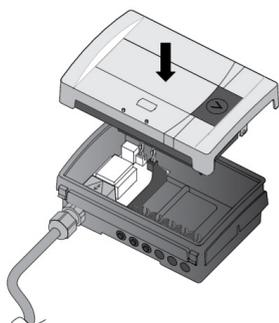
9. Fermez le boîtier en vous assurant qu'aucun câble n'interfère avec le joint en caoutchouc ou les autres pièces internes. Mettez le compteur sous tension.
