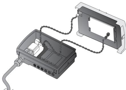
8. Raccordez le module d'alimentation secteur au circuit imprimé et au module de communication. Fiche [blanche] gauche pour le compteur (pour avoir une alimentation de secours en cas de coupure de courant). Droite [noire] pour le module.
