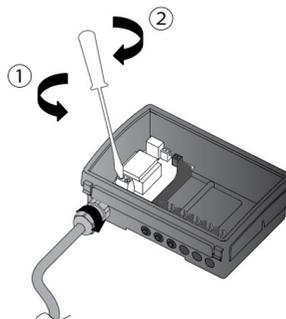
6. Raccordez le câble et fixez-le aux bornes à vis. Serrez le presse-étoupe.
