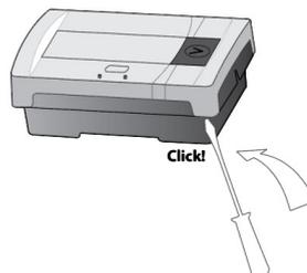
2. Rompez le joint d'installation des deux côtés et ouvrez le boîtier.
