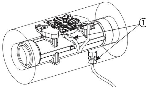
Position du calculateur : installez le calculateur plus haut que le capteur de débit, séparé du tuyau.
