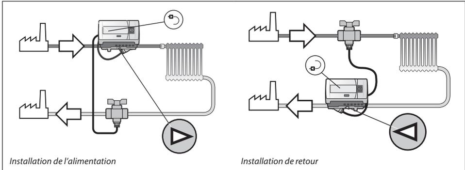
**Remarque :** Les compteurs de chaleur et les compteurs bifonctionnels disposent d'une sonde de température rouge dans le tuyau d'alimentation et tous les compteurs de refroidissement d'une sonde de température bleue dans le tuyau d'alimentation.
