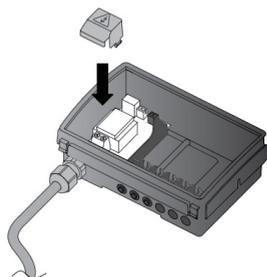
7. Fixez le raccordement câble-borne à l'aide d'un capuchon de protection.
