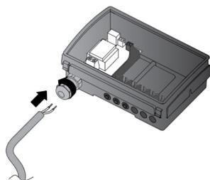
5. Insérez le câble dans l'orifice du presse-étoupe pour fixer le collier de câble conformément à la classe IP.
