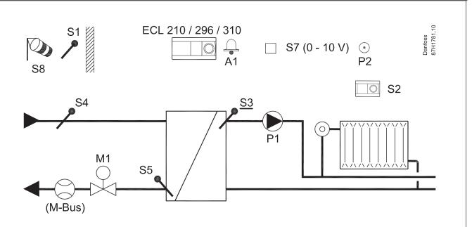
Système de chauffage raccordé indirectement. Compensation du vent et protection contre la condensation dans les bâtiments à forte inertie thermique en option. S2: ECA 31 dispose d'une sonde de T ambiante et d'une sonde d'humidité. Envoie le signal HR à l'ECL.
