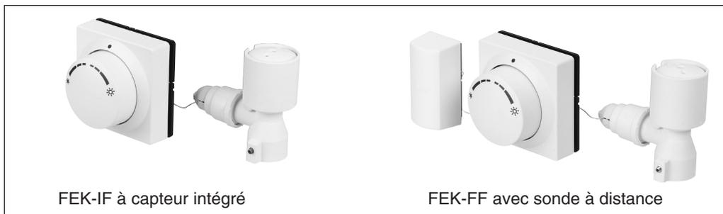
Le FEK est un système de régulation du circuit de refroidissement, de type proportionnel qui agit sur l'ouverture de la vanne en fonction de la température ambiante. Lorsque la température ambiante est supérieure à la température fixée, le capteur FEK ouvre la vanne de refroidissement.
