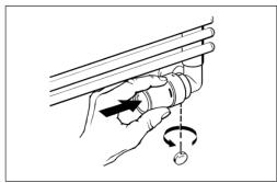
Le joint d'étanchéité est monté sur l'entrée et la sortie du radiateur avec une clé Allen de 17 mm. La vanne et la vanne de coupure sont de conception
