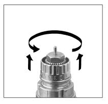
Les corps de vannes Danfoss pré-réglables sont équipés de bagues de réglage intégrées graduées de 1 à 7 plus une position N. Pas besoin d'outils de réglage. Le réglage est facile, rapide et précis et il est effectué de la façon suivante :
