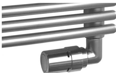
Les robinets thermostatiques de la collection X-tra™ ont été conçus spécialement pour les radiateurs sèche-serviettes et décoratifs. Grâce à la vanne 1/2" avec joint d'étanchéité intégré le raccordement au radiateur est effectué de façon simple, esthétique et sans problème.
