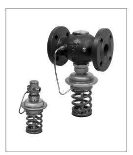
AVA est un régulateur de pression auto-moteur principalement utilisé dans les systèmes de chauffage centralisés. Il est normalement fermé et s'ouvre lorsque la pression en amont augmente.
