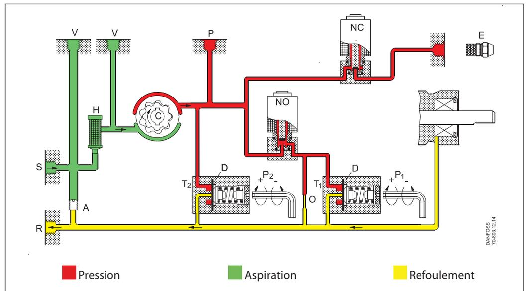
Au démarrage de la pompe, le fioul est aspiré depuis la conduite d'aspiration (S) à travers le filtre (H) jusqu'à l'engrenage (C).
