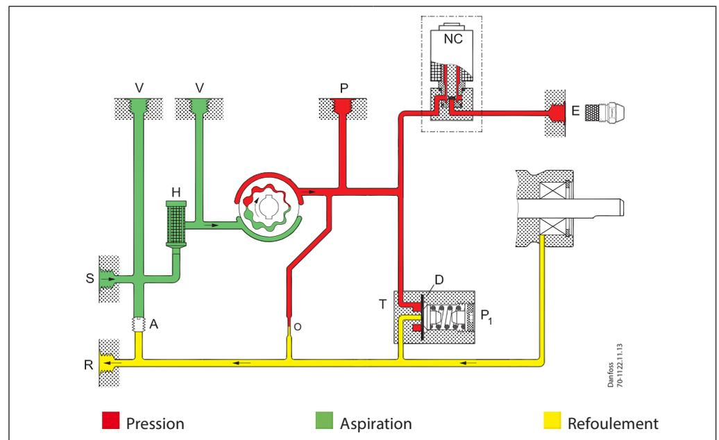
Au démarrage de la pompe, le fioul est aspiré depuis la conduite d'aspiration (S) à travers le filtre (H) jusqu'à l'engrenage. Ce dernier refoule le fioul sous pression. Lorsque l'électrovanne (NF) est mise sous tension, elle s'ouvre et laisse passer le fioul jusqu'au gicleur.
