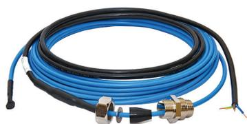
Le DEVlaqua™ 9T est un câble chauffant à double conducteur bleu clair, rond, résistif, entièrement blindé, de haute qualité, avec une gaine extérieure résistante et un raccord de tuyau spécial de 3/4" et 1". Il est homologué pour une utilisation en contact
