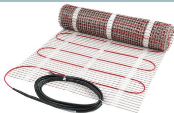
DEVImat™ est une trame chauffante constituée d'un treillis autocollant de très haute qualité, entièrement blindée à 360°, doté de conducteurs isolés FEP et une gaine extérieure en PVDF rouge
