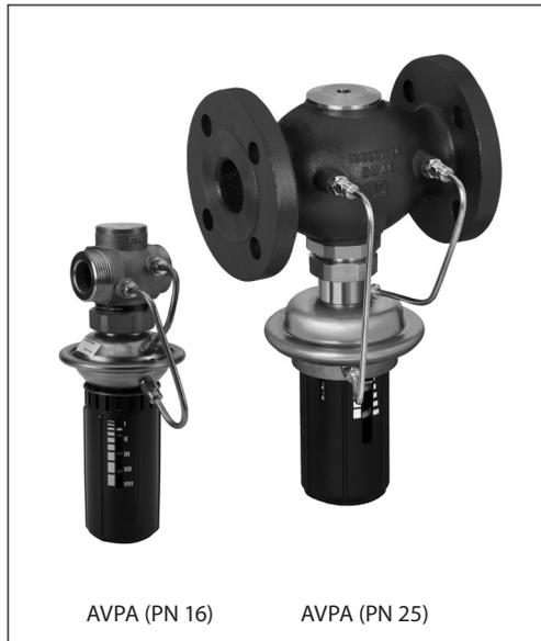
L'AVPA est un régulateur de pression différentielle automoteur principalement utilisé sur les réseaux de chauffage urbain. Il est normalement fermé et s'ouvre lorsque la pression différentielle augmente.
