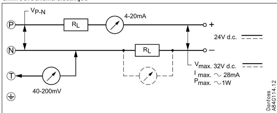
Le transmetteur dispose d'un schéma de câblage, voir la figure ci-dessus. Les bornes P (positives) et N (négatives) sont les bornes de connexion pour la tension d'alimentation.
