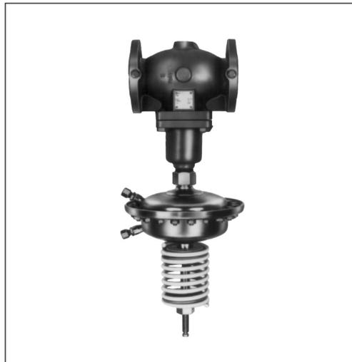
Le régulateur comporte une vanne de régulation, un actionneur à membrane d'équilibrage et un ressort pour le réglage de la pression différentielle.
