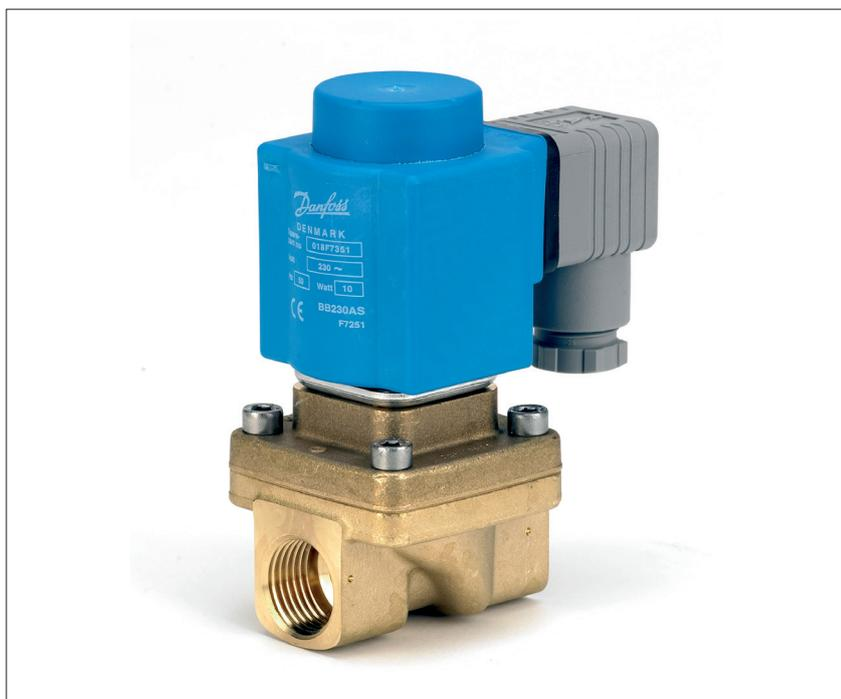
EV250B est un programme d'électrovanne 2/2 à membrane attelée. Elle fonctionne à partir d'une pression différentielle de zéro et jusqu'à 10 bar. Cette gamme est particulièrement utilisée dans les circuits fermés et pour les applications à basse pression différentielle requérant des débits modérés. Le corps de vanne en laiton résistant au dézingage garantit leur longévité même dans les cas d'utilisation avec des fluides agressifs ou de la vapeur.
