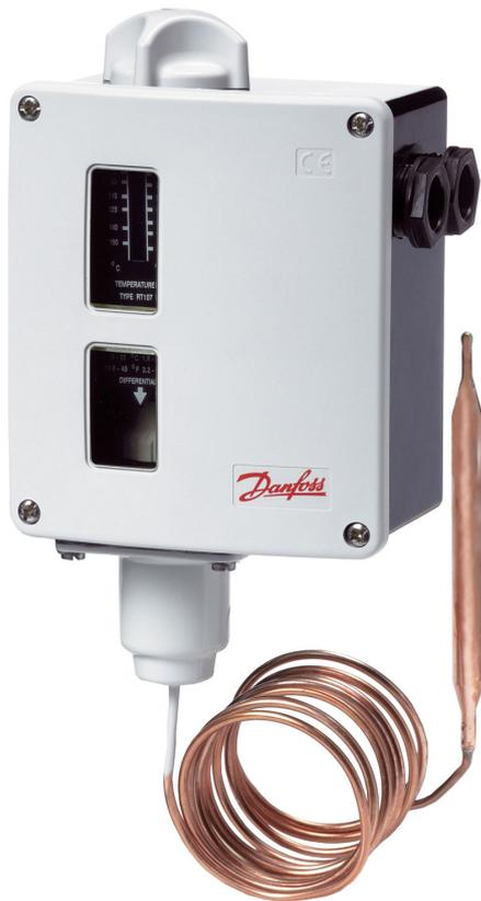
Les thermostats RT intègrent un inverseur unipolaire commandé par température dont la position dépend de la température du capteur et de la valeur de réglage.
