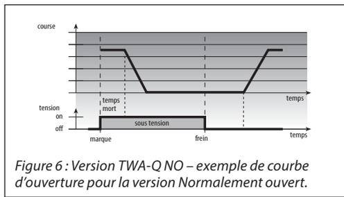
Figure 6 : Version TWA-Q NO – exemple de courbe d'ouverture pour la version Normalement ouvert.
