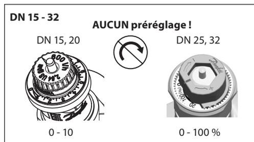
Aucun pré réglage ne doit être effectué sur les vannes AB-QM. La vanne doit être entièrement ouverte (10 = AB-QM 4.0, 100 % = AB-QM)
