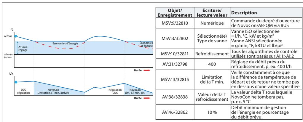
État 5 : Réglage de la régulation Delta T (exemple : eau de chauffage)
