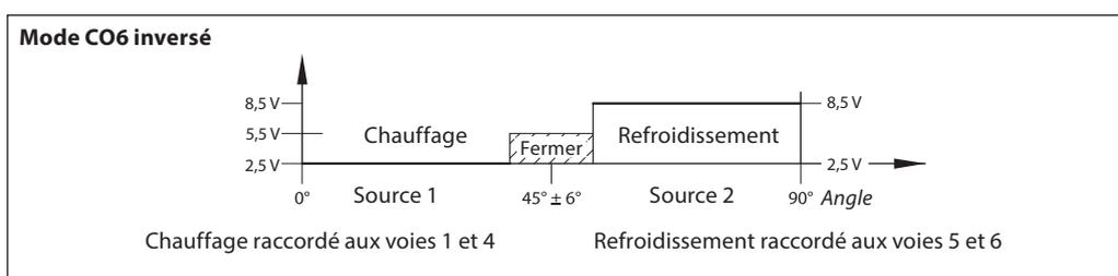
Signal du NovoCon® S vers l'actionneur NovoCon® ChangeOver®
