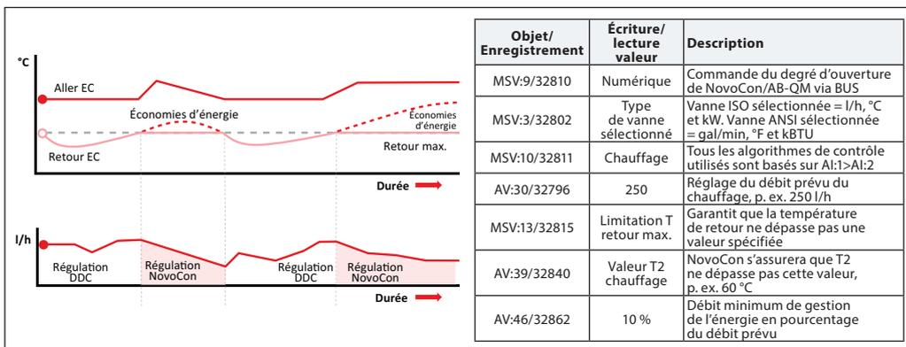
**État 7 : Réglage de la régulation de la température de retour (exemple : eau de chauffage)**
