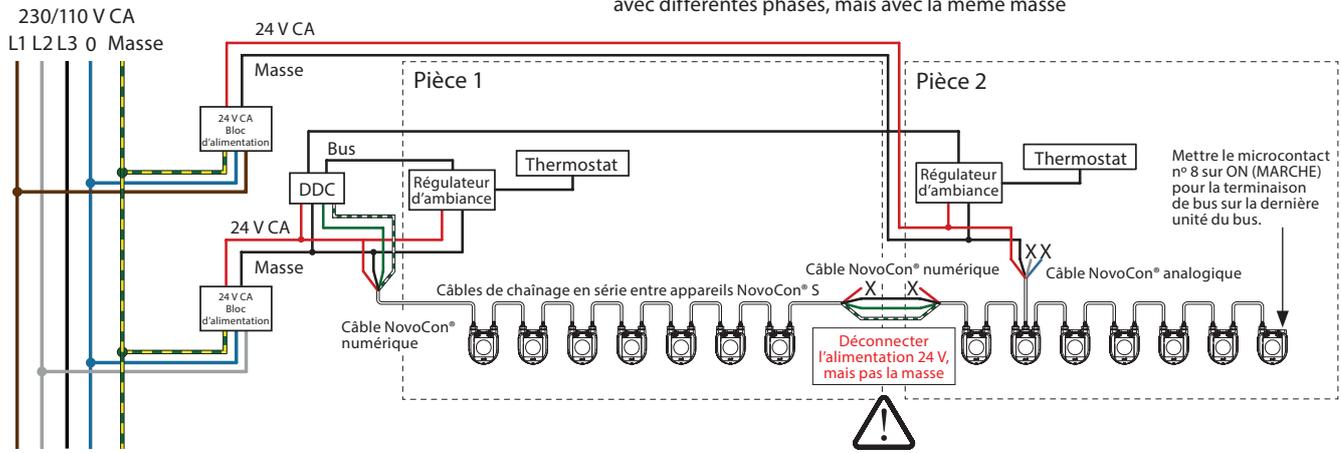
La terminaison des fils avec un « X » doit être appropriée.
