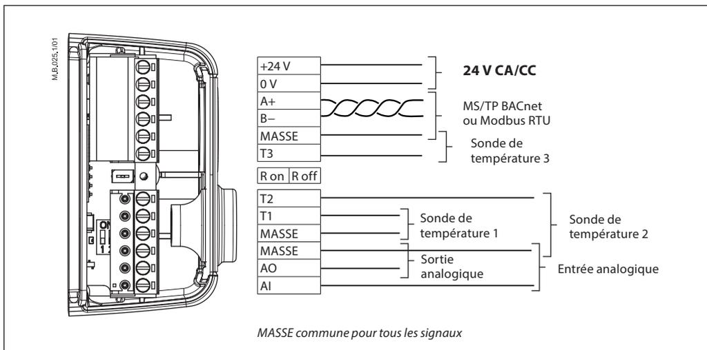
**Pour des performances optimales, Danfoss recommande d'utiliser NovoCon® M sur son propre sous-réseau.**
