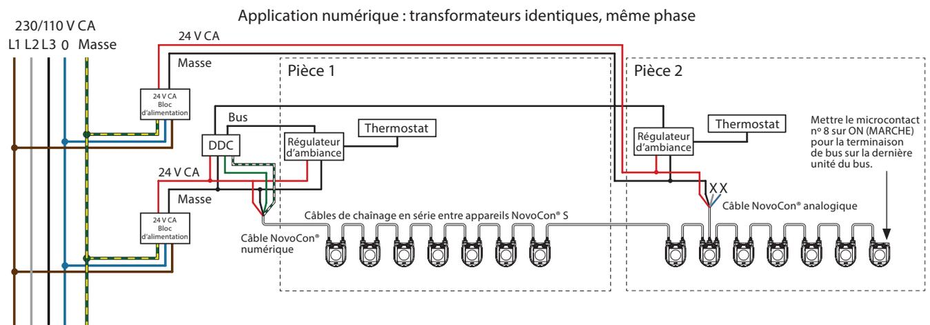
**⚡** Si le réseau NovoCon® S est alimenté par deux amplificateurs de puissance CA ou plus, il faut faire attention au moment de débrancher un des transformateurs de la ligne d'alimentation haute tension. Comme les NovoCons sont connectés en série, il peut y avoir une haute tension du côté primaire de l'alimentation électrique débranchée. Toujours déconnecter les côtés primaire et secondaire du transformateur.
