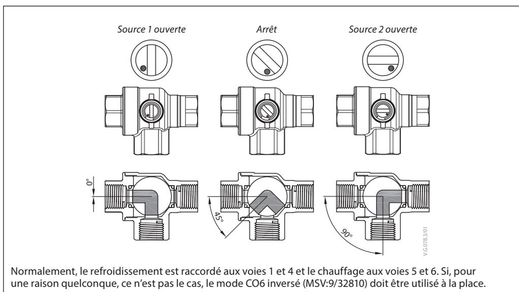
Contrairement aux autres vannes à bille, CO6 comprend une fonction d'arrêt. Cette fonction doit être utilisée uniquement pendant la maintenance et pas pendant l'utilisation. Quatre vannes à bille sont dans ce cas inutiles. La commande d'arrêt ne peut être exécutée que lorsque la consigne du débit (AV:1/33280) est égale à 0.
