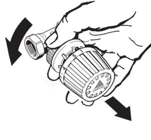
Démontage : tourner la bague à fond dans le sens anti-horaire et dégager la tête.
