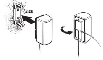
La sonde à distance ne doit ni être placée dans un courant d'air, ni être couverte.
