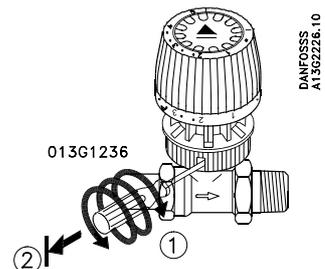
Pour démonter la tête , utiliser l'outil spécial fileté pour dégager légèrement le dispositif antivol jusqu'à la butée.
