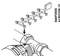
Placer le dispositif dans le creu de la vis hexagonale.
