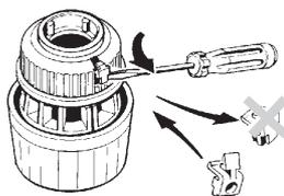
Oter l'obturateur et le remplacer par le dispositif antivol sans l'enfoncer à fond.
