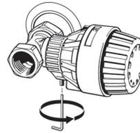
Fixer la tête en serrant la vis à l'aide d'une clé Allen de 2 mm.
