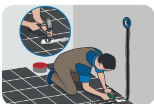
Une sonde de dalle est obligatoire et doit être raccordée à un thermostat limitant la température du plancher à 28 °C maximum.
