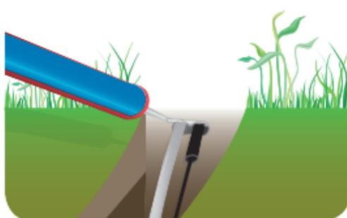
Rallongez les liaisons froides avec des jeux de raccords et placez les raccordements à un endroit sec. Étancheïsez toutes les ouvertures dans les murs ou dans les structures similaires. Appliquez du ruban d'avertissement sur les liaisons froides.
