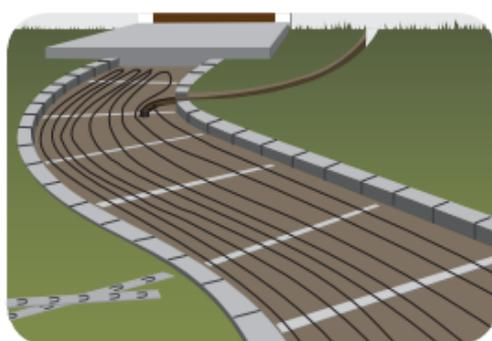
Préparez la surface d'installation avec des accessoires de fixation Danfoss CLIP et/ou une armature en treillis. Fixez le conduit du câble de sonde et le tube/élément factice de sonde pour la sonde ECtemp 850, le cas échéant.
