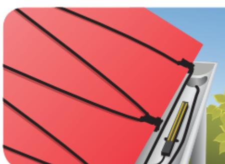
L'élément doit être régulé en température et ne doit pas fonctionner à une température ambiante supérieure à 10 °C pour des applications extérieures.
