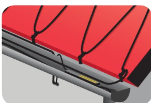
Étendez les câbles de la sonde et les liaisons froides et placez les raccordements dans un endroit sec. Étanchez toutes les ouvertures dans les murs ou les toits par exemple.
