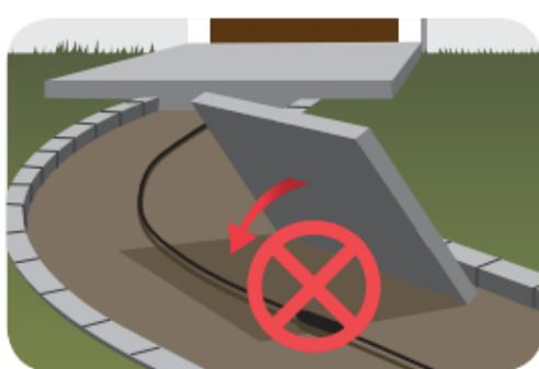
Les éléments et en particulier le raccordement doivent être protégés contre toute contrainte ou déformation.
