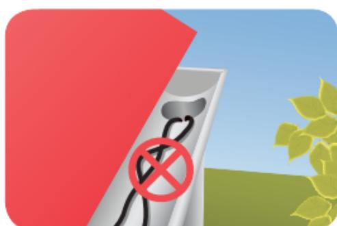
Les éléments ne doivent ni être en contact les uns avec les autres ou avec d'autres éléments, ni se croiser ou croiser d'autres éléments. Ils doivent être répartis de manière homogène sur les surfaces.
