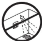
Il ne faut pas installer le thermostat/commutateur dans une pièce humide. Le thermostat/commutateur doit être placé en dehors de la zone 2. Placez-le dans une pièce adjacente et utilisez uniquement une sonde de dalle. Placez-le toujours conformément aux réglementations locales relatives aux classes IP.
