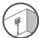
Placez le thermostat à une hauteur convenable sur le mur (généralement 80-170 cm).
