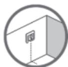
**Remarque :** une sonde de dalle permet de réguler la température avec plus de précision. Son installation est donc recommandée pour toutes les applications de plancher chauffant et **obligatoire** sous les planchers en bois pour éduire le risque de surchauffe du sol.
