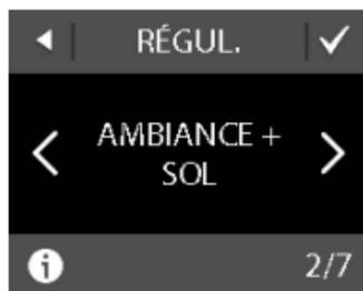
Remarque : une option « sonde d'ambiance seule » peut également être disponible. Pour plus de détails, se reporter à la section « Température du plancher maximale ».
