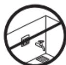
Il ne faut pas installer le thermostat dans une pièce humide. Placez-le dans une pièce adjacente. Toujours le placer conformément aux réglementations locales relatives aux classes IP.
