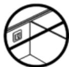
Ne pas placer le thermostat sur la surface interne d'un mur donnant sur l'extérieur.
