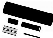
1. Dénuder la gaine extérieure et la gaine métallique (tresse) sur 20 mm environ, sans endommager la gaine isolante sous la tresse.
