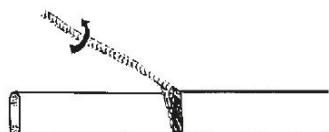
3. Isolierung 90 mm vom Ende einschneiden und entfernen.
