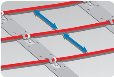
$$C - C [cm] = \frac{\text{Surface [m}^2\text{]}}{\text{Longueur de câble [m]}} \times 100 \text{ cm}$$
