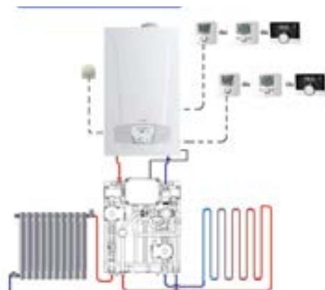
Luna Platinum + HTE avec 1 circuit direct + 1 circuit vanne 3 voies avec régulation sur chaudière
