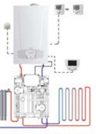
Luna Platinum + HTE avec 1 circuit direct + 1 circuit vanne 3 voies avec régulation en ambiance
