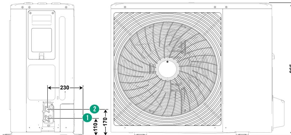
Raccordement fluide frigorigène:
