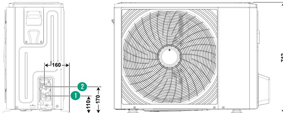
Raccordement fluide frigorigène:
