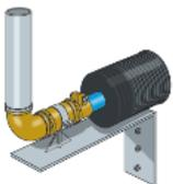
Des points fixes adéquats doivent être installés pour ancrer fortement les extrémités des canalisations (notamment aux pénétrations de mur). L'installation des points fixes est nécessaire et obligatoire afin de protéger l'installation et absorber les effets potentiels de la dilatation/rétraction des tubes caloporteurs en PE100.
