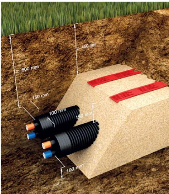
Toujours tenir compte de la profondeur de gel locale afin de déterminer la profondeur d'enfouissement des canalisations. Poser systématiquement la canalisation sur un lit de sable afin d'éviter d'endommager la gaine de protection extérieure en PE-HD. Ne combler complètement la tranchée qu'après avoir entièrement recouvert les canalisations enterrées par du sable en prenant soin de respecter les dimensions minimales indiquées sur le schéma joint.
