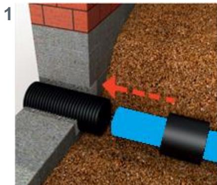
1 Le tube de protection annelé doit être scellé dans le mur et doit en dépasser de  $\pm 10$ cm vers l'extérieur afin de permettre la mise en place d'un manchon thermorétractable. Faire ensuite coulisser sur la gaine puits climatique le manchon thermorétractable sans le découper. Faire passer la gaine puits climatique dans le tube de protection annelé.
