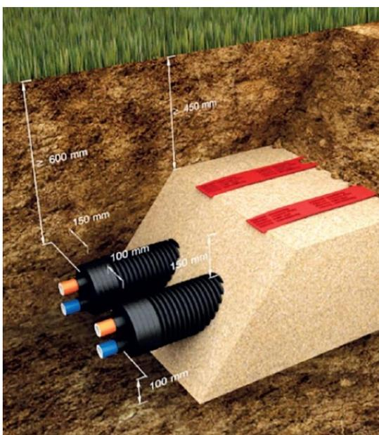
Pour faciliter le raccordement des dérivations sur le tube caloporteur principal, il est recommandé de positionner le tube pré-isolé double en faisant en sorte que les tubes caloporteurs en PER-a soient superposés (Voir schéma joint).
