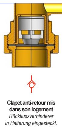
Note: la boucle avec le clapet anti-retour est retenue dans son logement par la tubulure vissée.
