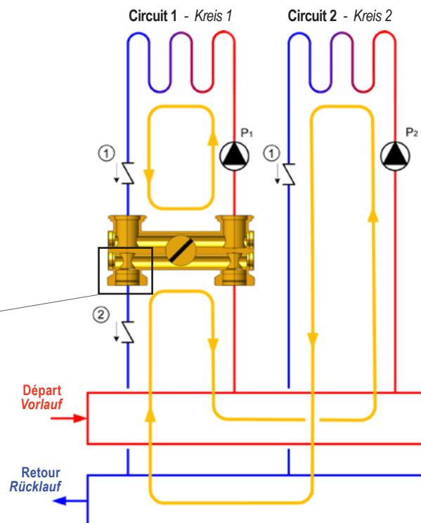
① ↪ Clapets anti-retour équipés en standard dans le module.
