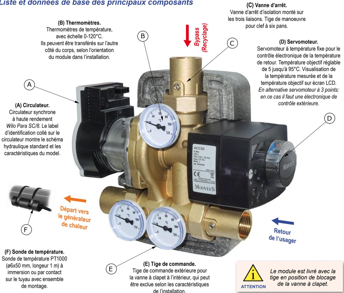
**ATTENTION** Le module est livré avec la tige en position de blocage de la vanne à clapet.
