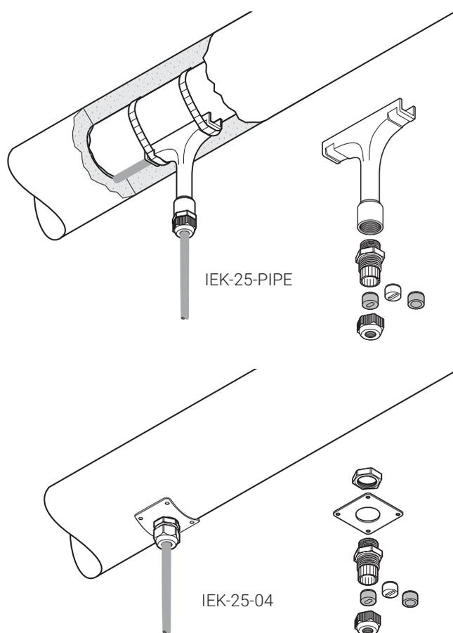
Les kits d'entrée de calorifuge sont conçus pour protéger les câbles à l'endroit où ils traversent le revêtement du calorifuge. Ils s'adaptent à tous les câbles chauffants parallèles et aux câbles d'alimentation. Les kits peuvent être utilisés en zones explosibles et non explosibles.
