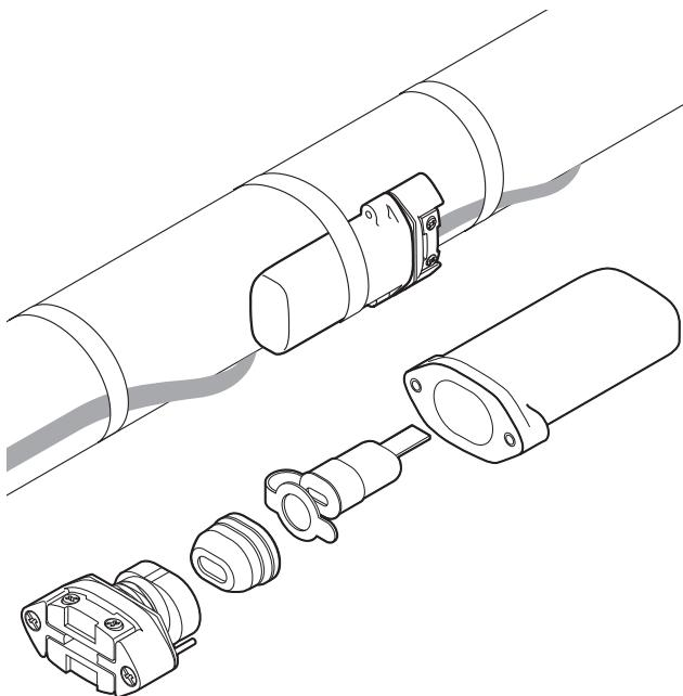
La terminaison nVent RAYCHEM E-150-E est une terminaison sous calorifuge, de faible épaisseur, installée à froid. Elle est conçue pour s'adapter à tous les rubans chauffants autorégulants nVent RAYCHEM à usage industriel BTV, QTVR et XTVR. Ce qui simplifie la sélection des produits et permet de réduire les stocks. Elle convient pour des applications à des températures comprises entre  $-55^{\circ}\text{C}$  et  $200^{\circ}\text{C}$  et est agréée pour un usage en zones explosives.
