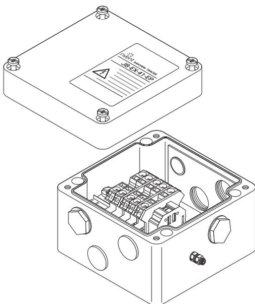
Boîte de raccordement en polyester industrielle avec plaque de masse pour usage en zones explosibles. Convient pour les connexions entre câbles d'alimentation, câbles chauffants et câbles de sortie froide avec kits de raccordement métalliques M25 ou presse-étoupes. La mise à la terre des connexions se fait via la plaque de masse.
