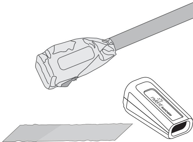
Kit de terminaison nVent RAYCHEM E-02-AL, appliquée à froid, est conçu pour terminer les rubans chauffants nVent RAYCHEM BSA.
