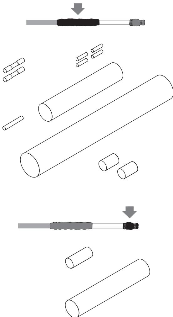
Le kit nVent RAYCHEM CSE-05-DR combine les caractéristiques suivantes : raccordement en ligne d'un ruban chauffant BSA à un câble d'alimentation flexible ou jonction en ligne de 2 rubans chauffants BSA, et terminaison du ruban chauffant BSA.
