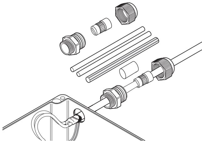
Ce kit de raccordement assure la liaison de tous les rubans chauffants industriels à circuit parallèle nVent RAYCHEM de type BSA et BTV-CR à une boîte de raccordement en zone ordinaire, tout en maintenant l'isolation électrique des conducteurs et de l'âme des rubans chauffants.
