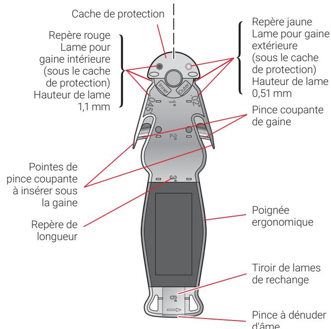
La pince à dénuder nVent RAYCHEM Stripping-Tool-SR-Cable peut être utilisée avec les rubans chauffants autorégulants nVent RAYCHEM de types BTV-CR, BTV-CT, QTVR-CT, XTVR-CT, HTV-CT, HWAT, XL-Trace, IceStop et RaySol. Cette pince permet de confectionner les rubans chauffants plus rapidement, de manière plus sûre et plus fiable.
