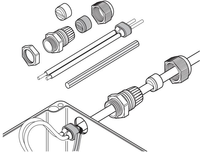
Ce kit de raccordement assure la liaison des rubans chauffants à circuit parallèle de type Raychem BTV, QTVR, XTV, KTV, HTV et VPL industriels à la boîte de raccordement tout en maintenant l'isolation électrique des conducteurs et de l'âme du ruban chauffant. Il est agréé pour un usage en zones explosives.
