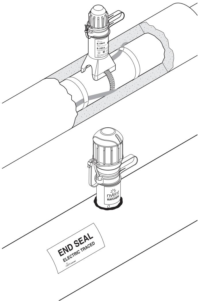
Les modèles nVent RAYCHEM E-100-E et E-100-L-E sont des modules de terminaison accessibles et rouvrables, le second étant équipé d'un témoin lumineux. Ils s'adaptent sur tous les rubans chauffants industriels parallèles de nVent RAYCHEM BTV, QTVR, XTVR, HTV ou VPL et sont agréés pour un usage en zones explosives. Leur boîtier robuste et moulé d'une épaisseur de 4 mm les rend extrêmement résistants.
