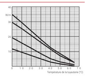
3BTV2-CR 5BTV2-CR 8BTV-2-CR 10BTV2-CR 3BTV2-CT 5BTV2-CT **8BTV-2-CT** 10BTV2-CT Puissance de sortie nominale (W/m à 10 °C) 9 16 25 29 **DIMENSIONS (VALEURS NOMINALES) ET POIDS DES PRODUITS** Épaisseur (mm) 5,5 5,5 5,5 5,5 Largeur (mm) 10,5 10,5 15,4 15,4 Poids (g/m) 110 110 153 153
