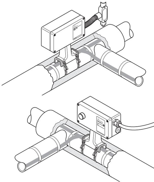
Le kit nVent RAYCHEM JBM-100 est conçu pour l'alimentation de un à trois rubans chauffants en circuit parallèle de type nVent RAYCHEM BTV, QTVR, XTV, KTV ou VPL pour applications industrielles. Il est agréé par FM, CSA et PTB pour un usage en zones explosibles. Le JBM-100 intègre les fonctions de raccordement et d'entrée de calorifuge. Son support robuste protège le ruban chauffant et autorise une épaisseur de 100mm (4") de calorifuge.
