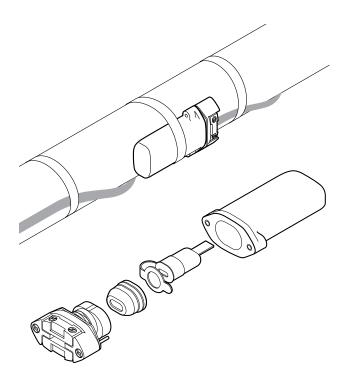
La terminaison nVent RAYCHEM E-150-E est une terminaison sous calorifuge, de faible épaisseur, installée à froid. Elle est conçue pour s'adapter à tous les rubans chauffants autorégulants nVent RAYCHEM à usage industriel (BTV, QTVR, XTV et KTV), ce qui simplifie la sélection des produits et permet de réduire les stocks. Elle convient pour des applications à des températures comprises entre -50 °C et 215 °C et est agréée pour un usage en zones explosibles.
