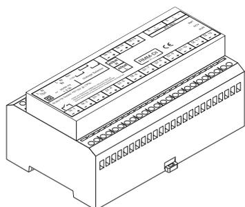
Le module de supervision distance des entrées numériques (RMM2-DI) permet de surveiller les entrées numériques du système NGC-30. Le RMM2-DI accepte jusqu'à 15 entrées TOR par module. Jusqu'à 247 modules RMM2-DI peuvent être connectés au système NGC-30. Le module RMM2-DI peut être installé dans une zone explosible ATEX / UKEx / IECEx Zone 2. Pour plus de détails, voir la fiche technique du RMM2-DI.
