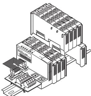
Le système NGC-30 intègre également des fonctions de régulation. Les modules de régulation à distance (RMC) fournissent des sorties relais multiples pour commander les relais sur chaque circuit de traçage. Les entrées de température proviennent des modules de surveillance à distance (RMM) tandis que l'interface UIT contrôle le système.
